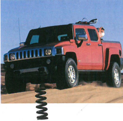
شكل (١-٧) سيارة يستخدم فيها زنبرك لرفع جسم السيارة عن محور الإطارات
