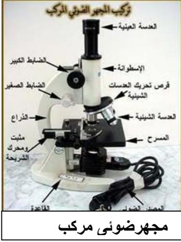
المجهر (Microscope) هو جهاز يختص بتكبير الأشياء والأجسام الصغيرة مما يسهل دراستها، وهو مفيد بشكل خاص لعلماء الأحياء الذين يقومون بدراسة الكائنات الحية، والخلايا التي تحتاج إلى وسائل وتقنيات متطورة لتسهيل دراستها. لا تقتصر وظيفة المجهر على التكبير أي إظهار المادة التي يتم دراستها بحجم أكبر، بل تتعداها إلى إظهار التفاصيل، وهو ما يُعرف بالتمييز .
