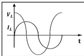
4- دائرة التيار المتردد التي يكون بها الجهد متقدما على التيار الكهربائي هي الدائرة
